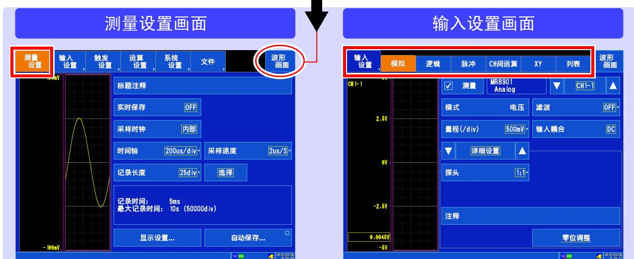
设置输入通道。也可以设置通道的显示方式或各种功能。
