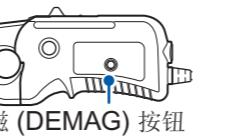
2 数次打开/关闭钳口，查看连接设备的显示，确认偏移输出稳定
