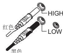
将红色插头连接到**HIGH**端子上，将黑色插头连接到**LOW**端子上。
