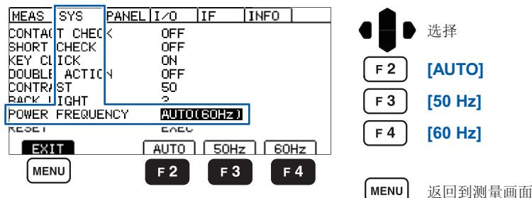
仅在打开电源时进行1次电源频率的自动识别。
