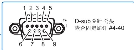
与控制器(DTE)连接时,请准备符合本仪器侧连接器及控制器侧连接器规格的交叉线。
