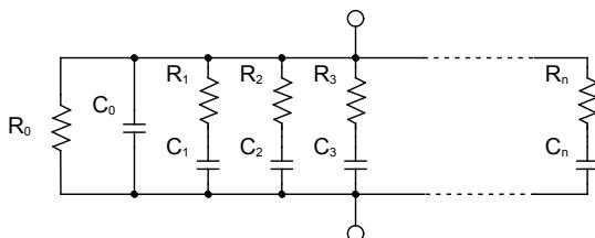
图1 绝缘物的等效电路
