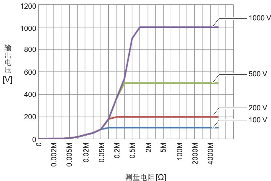
输出电压受到测量电流 1.8 mA 的限制。
