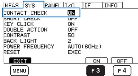
确认接触不良或接触状态(接触检查功能)
