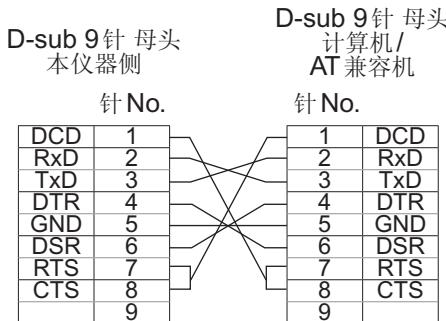
推荐电缆：HIOKI 制 9637 RS-232C 电缆 (1.8 m)
