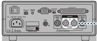
将红色插头连接到内侧的**HIGH**端子上，将黑色插头连接到内侧的**LOW**端子上。
