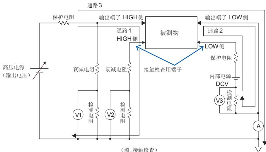
可利用本仪器分别对输出端子 HIGH 侧与 LOW 侧独立进行接触检查。其原理如下所示。
