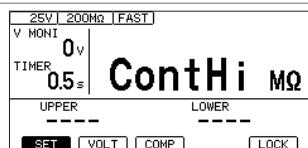
**LOW**侧接触检查的确认
