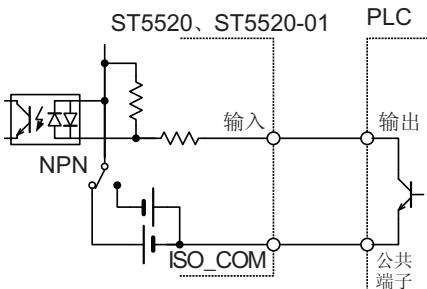
与PLC输出(NPN输出)的连接
