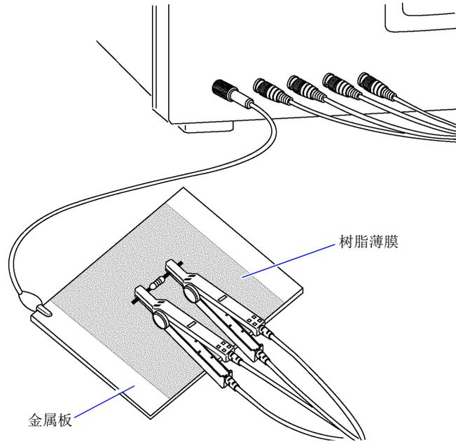
在金属板表面进行测量时，请用树脂薄膜等进行绝缘，以免端子类发生短路。
