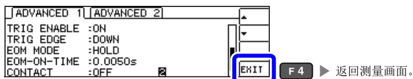
**注记** • 如果将接触检测时序设为 [BOTH] 或 [BEFORE]，触发同步输出功能则被自动设为 ON。
