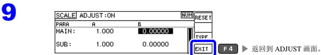
**注记** 如下述设置所示，MAIN、SUB 参数均设置相同参数并设置不同的补偿系数时，按 MAIN 参数的补偿系数执行转换比。（SUB 参数的补偿系数变为无效状态）
