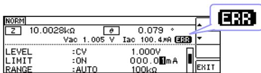
施加在测试物上的电压或流过测试物的电流超出限值时
