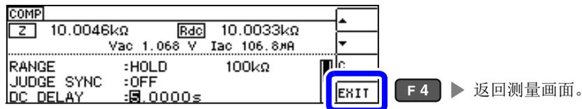
**注记** 直流信号电平达到稳定状态的时间因要测量的测试物而异。为了进行正确的测量，请事先观测测量波形，设定直流信号电平达到充分稳定状态的延迟时间。
