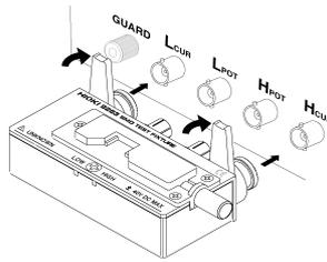
将印有产品名称的面朝上，直接插入到测量端子中，然后用左右的把手固定。
