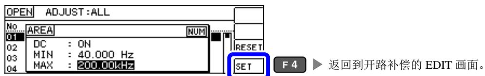
**注记** 最大补偿频率小于最小补偿频率时，自动调换最小补偿频率与最大补偿频率。
