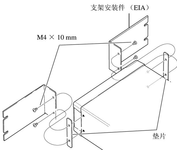
**2** 将垫片放入主机侧面两侧，然后用 M4 × 10 mm 螺钉固定支架安装件。
