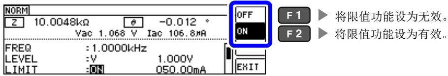
4 输入电流限值、电压限值。 **DIGIT**
