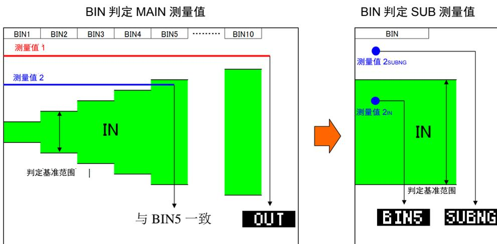
BIN 判定首先利用 MAIN 测量值进行判定，然后输出利用 SUB 测量值判定的结果。
