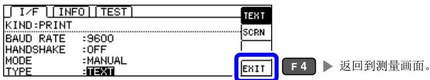
与打印机之间的通讯速度（波特率）设置以及流控制设置与 RS-232C 设置通用。通过变更通讯速度设置，有时也可能会提高打印速度。但也需要变更打印机的通讯速度设置。另外，提高通讯速度时，可能会导致与打印机的打印不协调，造成无法正常打印。此时，请使用硬件流控制或软件流控制。详情请参照打印机附带的使用说明书。
