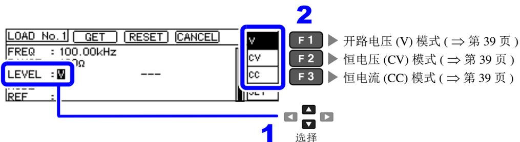
2 输入补偿信号电平的电压或电流值。 **DIGIT**
