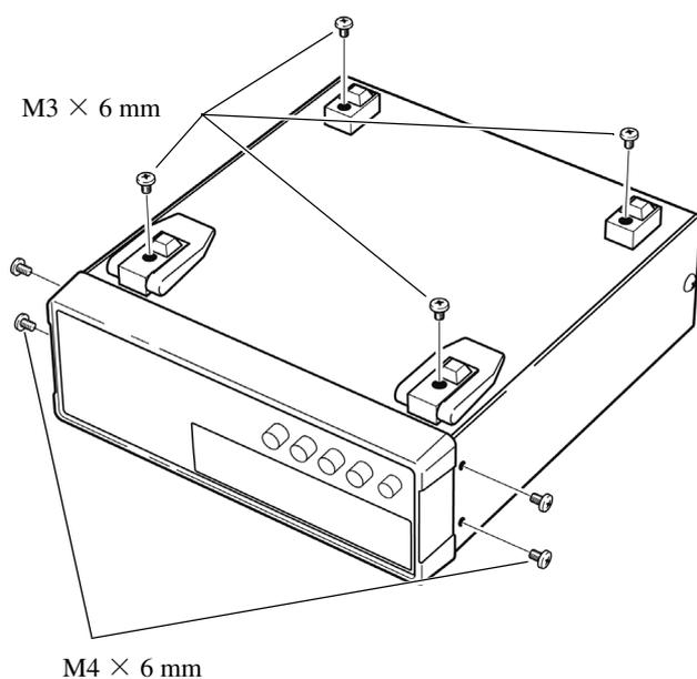
**1** 拆下主机底面的支撑脚和侧面盖子的螺钉（正面两侧 4 个）。
