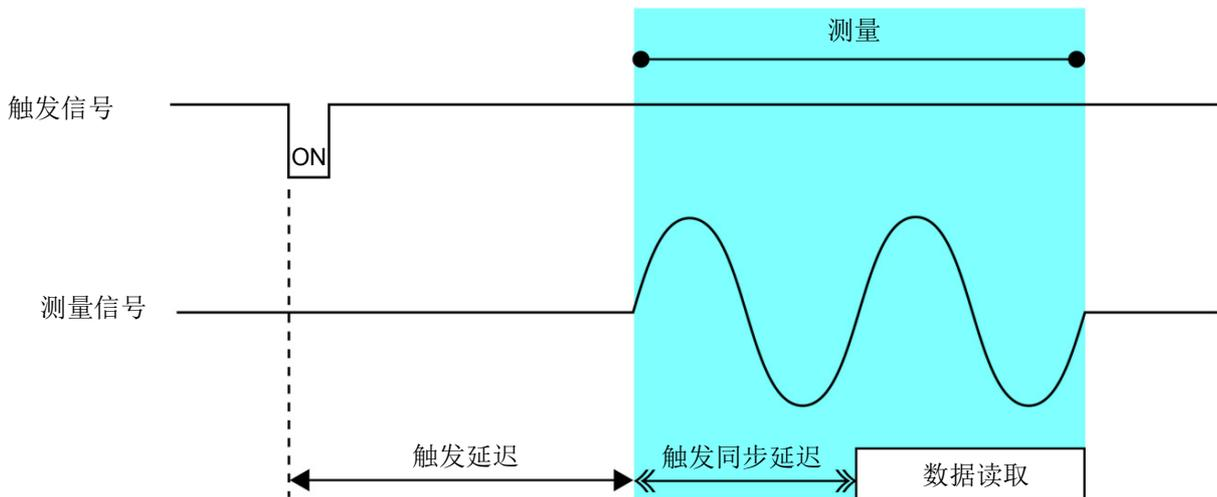
**注记** 量程同步功能有效时，仅触发延迟与同步输出功能的通过参数设置而生效的量程设置不同。
