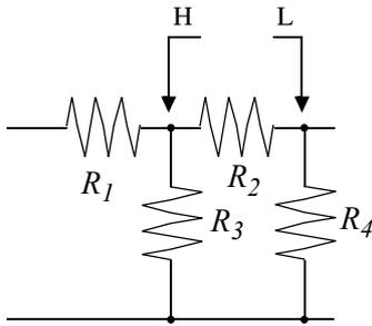
在图中，测量电阻  $R_2$  的电阻值时，即使将探头抵在电阻  $R_2$  的两端，流过电阻  $R_2$  的电流与通过电阻  $R_3$ 、 $R_4$  流过的电流也会被加在一起，测量左面所示的并联电阻。
