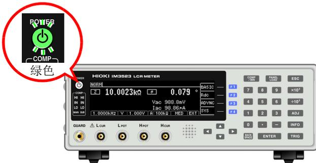
为了进行符合规格精度的测量，打开本仪器的电源之后，请进行 60 分钟以上的预热。
