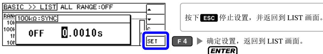
**注记** 将触发同步输出功能设为 ON 时，由于输出测量信号之后～读取数据之前需要等待时间，因此测量时间会延长。
