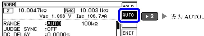
在精度保证范围以外，AUTO 量程可能不会正常进行动作，无法确定量程。在这种情况下，请利用“11.2 测量范围与精度”（⇒ 第 199 页）确认精度保证范围，变更测量条件。
