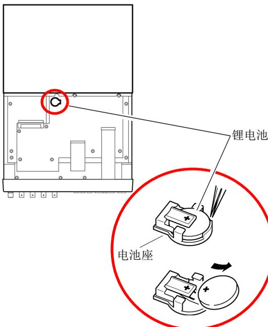
**1** 确认电源已关闭，然后拆下电缆和电源线。
