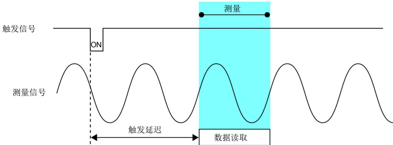
触发延迟：ON，触发同步输出：ON
