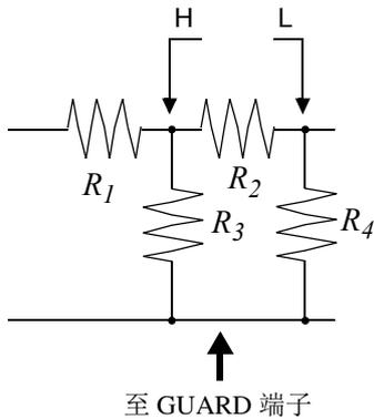
如图所示，如果使用 GUARD 端子，电流则不会流过电阻  $R_4$ ，流过电阻  $R_3$  的电流被 GUARD 端子吸收，此时可测量电阻  $R_2$  的电阻值。
