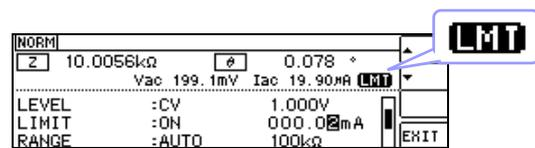
如果未向测试物施加超出限值的电压或电流, 并且未达到测量信号电平的设置时, 则停止测量信号电平的变更。
