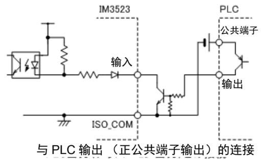
输出电路的连接举例
